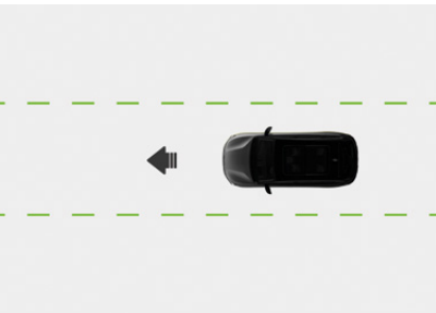
System aktywnego utrzymania pasa ruchu (LKA) Automatyczne utrzymanie pasa ruchu poprzez dokonywanie korekty na kierownicy, realizowane w momencie gdy kamera wykryje możliwość bezwiednego najazdu na linie pasa ruchu.
