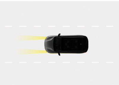
Asystent świateł drogowych (HBA) Automatyczne włączanie i wyłączanie świateł drogowych po wykryciu pojazdu zbliżającego się z naprzeciwka, co przyczynia się do zwiększenia bezpieczeństwa podczas jazdy po zmroku.
